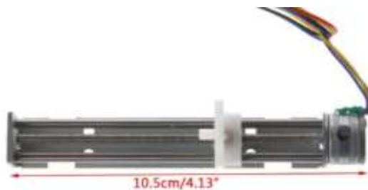
Hình 3.5: Bộ động cơ bước và hệ vitme
