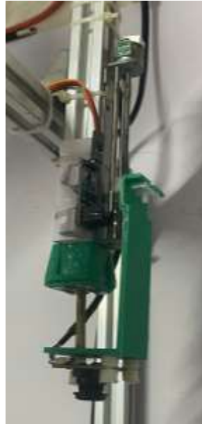
Hình 3.9: Cơ cấu điều chỉnh độ cao camera
