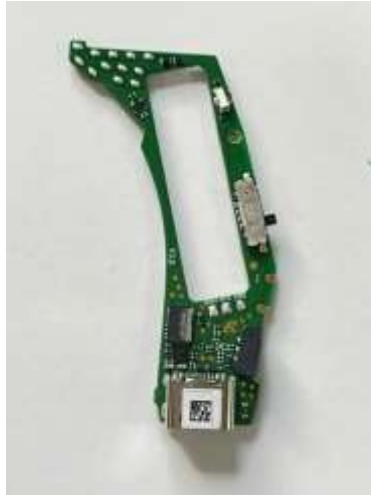
Hình 3.6. PCBA có linh kiện trên cả 2 mặt tại công ty, mặt trước
