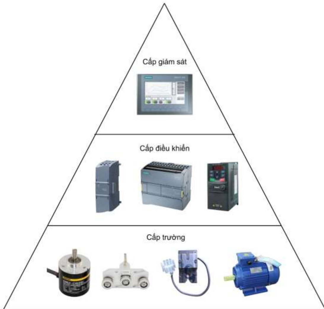
Hình 2.1 Sơ đồ phân cấp hệ thống.
