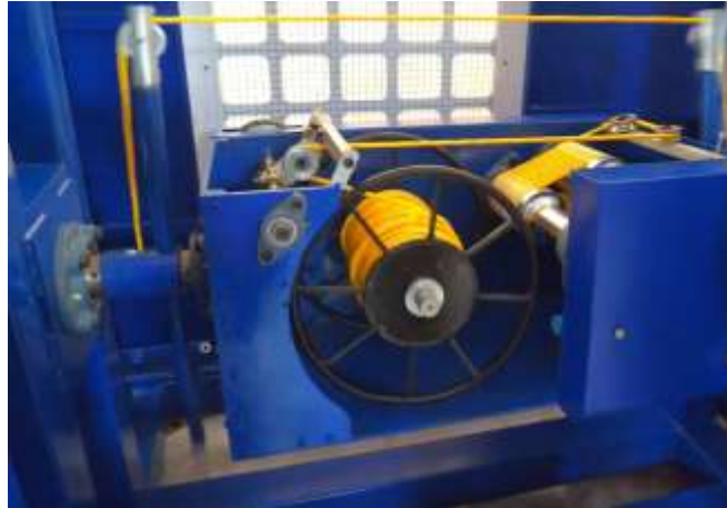
Hình 1.6 Cánh quay tạo sợi.
