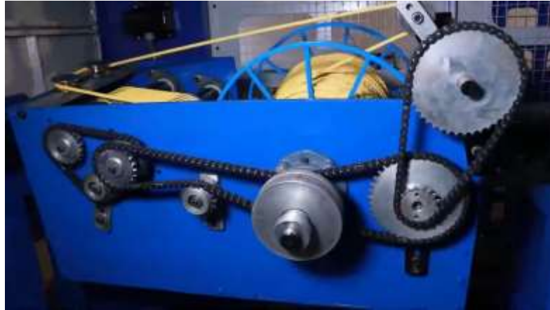
Hình 1.8 Truyền động xích.
