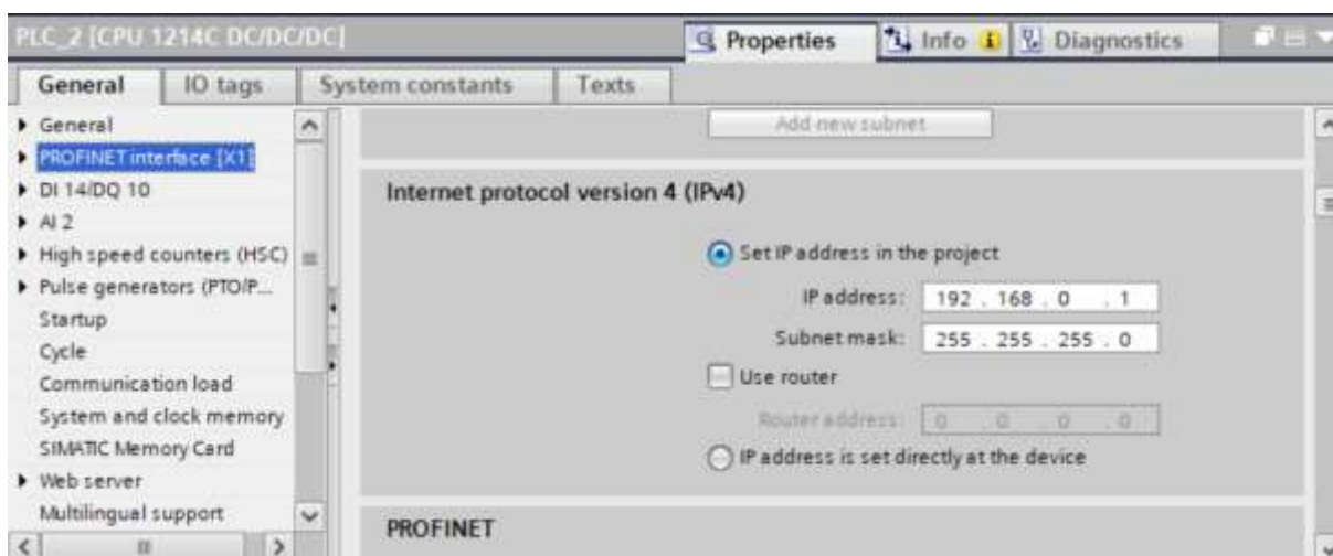
Hình 5.2 Cấu hình địa chỉ PLC.
