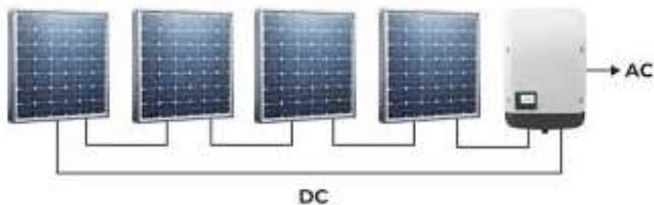
Hình 1. 5 Cấu trúc sử dụng string inverter
