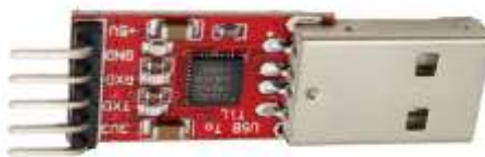
Hình 3. 13 Mạch chuyển đổi USB to TTL CP2102
