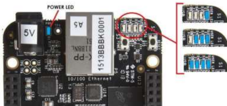
Hình 3. 9 Nút nhấn và đèn Led trên Board BeagleBone Black.
