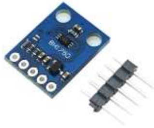
Hình 3. 12 Cảm biến ánh sáng BH1750
