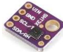
Hình 3. 11 Cảm biến nhiệt độ, độ ẩm SHT30
