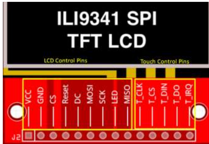
Hình 4. 4 Sơ đồ chân của LCD ILI9341
