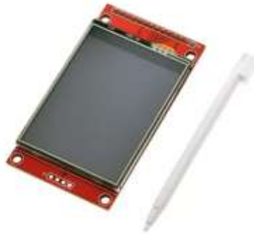
Hình 3. 16 Màn hình LCD ILI9341.
