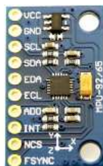
Hình 1.5. Cảm biến MPU9250
