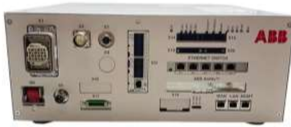
Hình 1.3. Bộ điều khiển Ominicore C30
