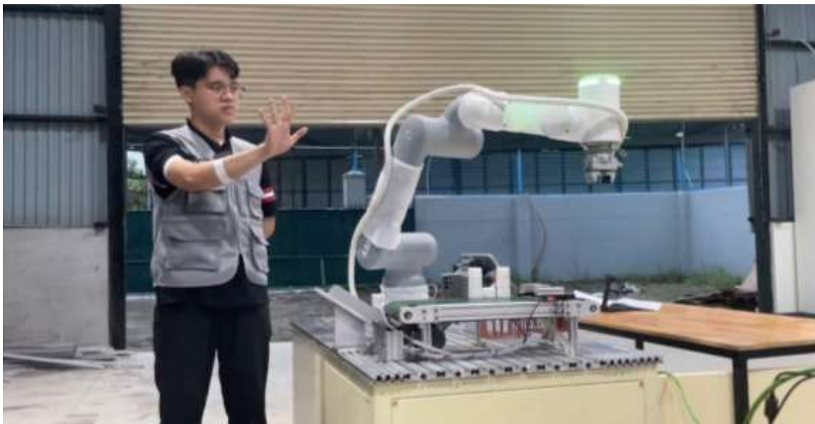
Hình 4.4. Điều khiển robot thông qua cử chỉ tay
