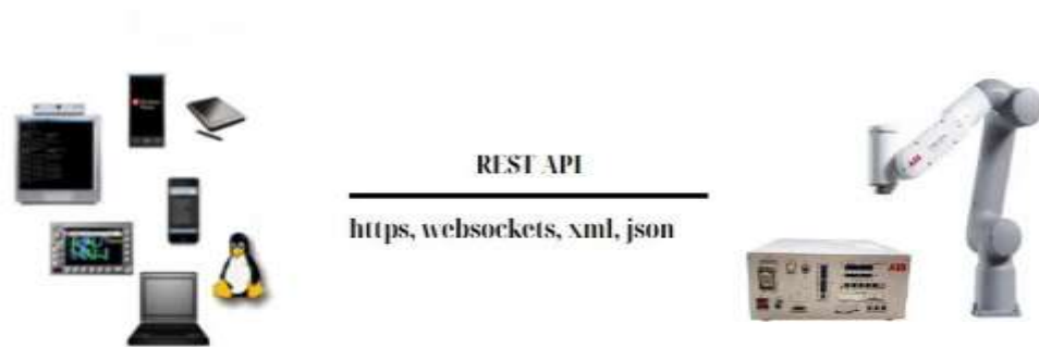
Hình 1.11. Truyền thông robot với PC thông qua RWS
