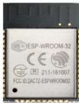
Hình 1.7. Chip xử lý vi điều khiển ESP32
