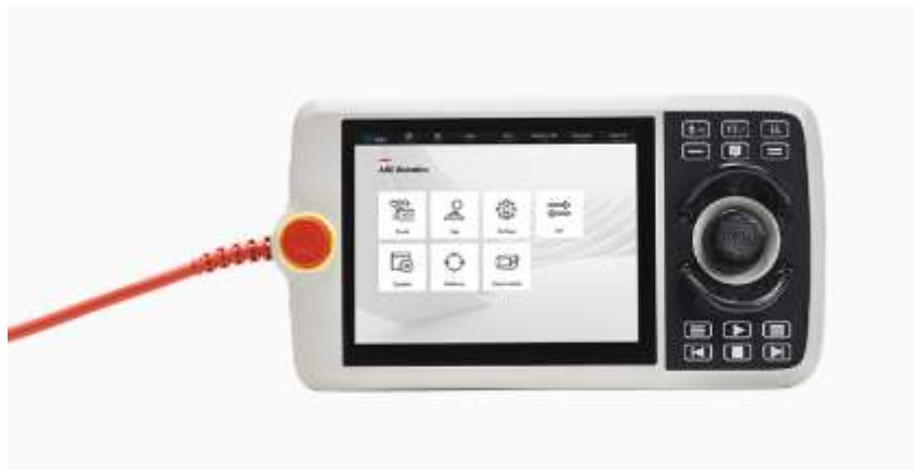
Hình 1.4. Tay cầm điều khiển Robot Gofa CRB 15000
