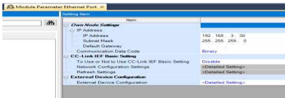
Hình 3.8 Cấu hình IP cho PLC
