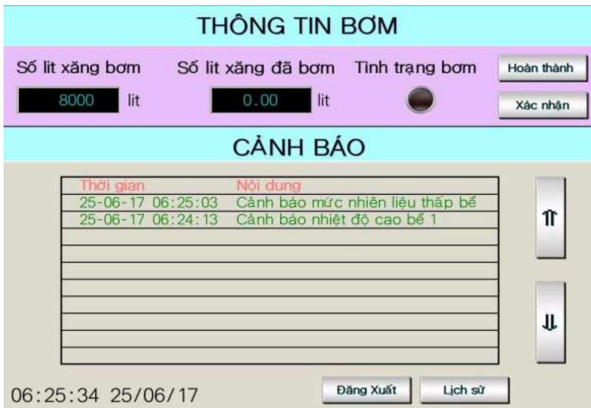
Hình 4.13 Giao diện chính màn hình HMI
