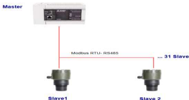
Hình 2.15 Mô hình truyền thông Modbus RTU
