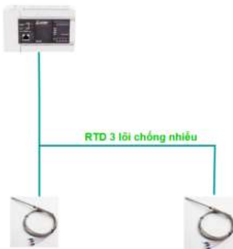
Hình 2.16 Mô hình kết nối tín hiệu analog đến PLC
