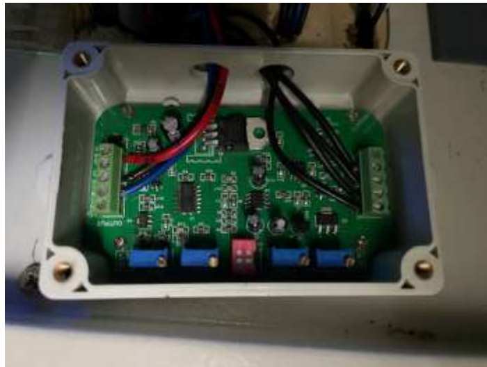
Hình 3.12 Hình ảnh đấu dây bộ chuyển đổi tín hiệu
