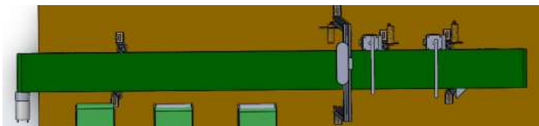
Hình 3.4 Băng tải gom được thiết kế trên phần mềm Solidwork
