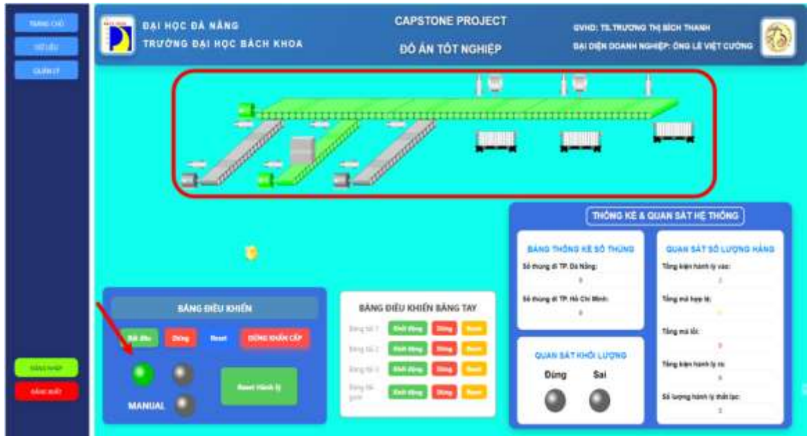
Hình 5.16 Trạng thái băng tải hoạt động trên màn hình giám sát
