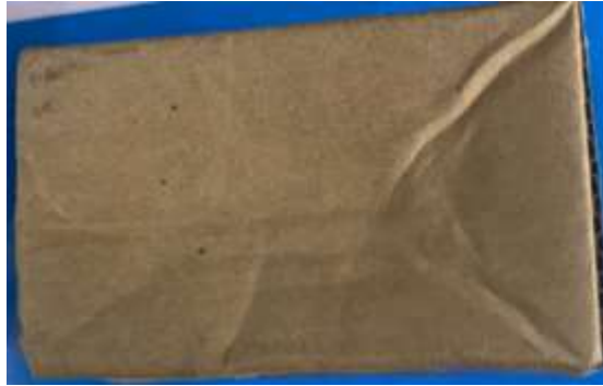
Hình 4.7 Sản phẩm biến dạng bề mặt dán tem
