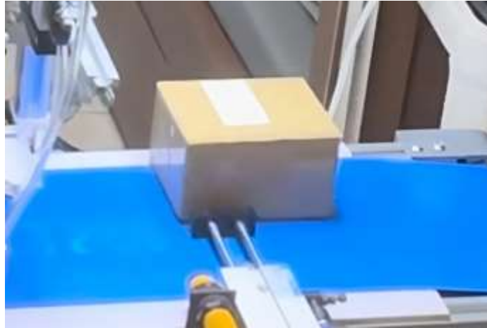
Hình 4.11 Xi lanh đẩy hộp dán tem bị lỗi
