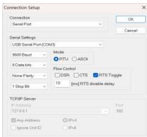
Hình 3.8. Connection Setup trên Modbus Slave.
