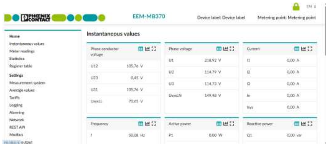
Hình 4.4. Thông số đọc trên HMI đi kèm với power meter (1)
