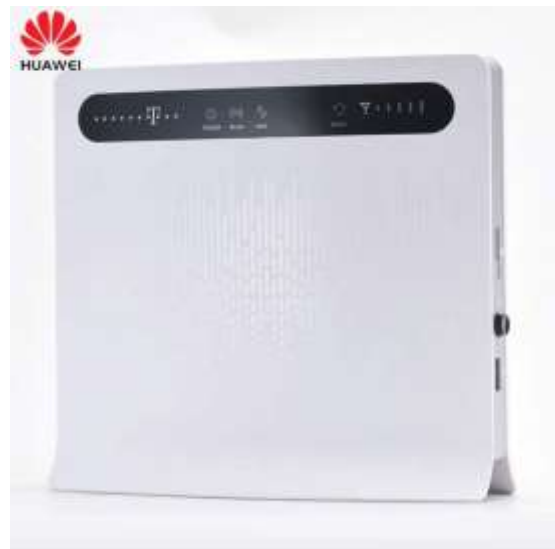
Hình 4.8. Gateway router WiFi 4G
