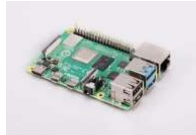
Hình 4.3. Raspberry Pi 4B
