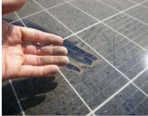
Hình 1.6. Bụi bám tích tụ trên bề mặt mô-đun quang điện
