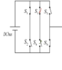
Hình 2.22 Trình tự V2: S1 và S2 đóng, S3 mở
