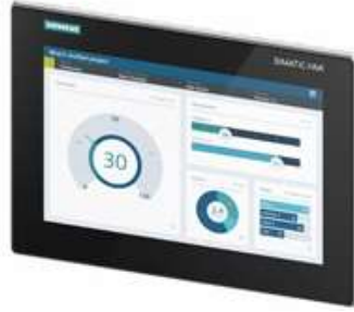
Hình 3.5. SIMATIC HMI MPT 1200.
