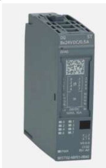
Hình 2.8. Module I/O – Module tín hiệu
