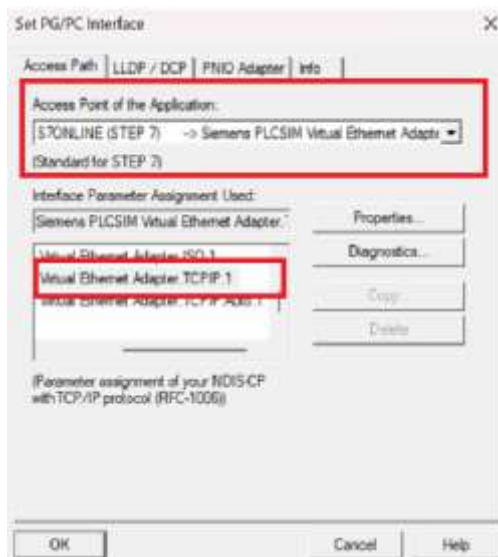
Hình 3.46. Thiết lập 'Access Point of the Application'
