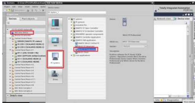
Hình 3.43. Lựa chọn SCADA tương ứng với hệ thống Trong Device view của PC Station, từ Hardware catalog, chọn module IE General (trong mục Communication) và kéo thả vào Rack của PC Station.
