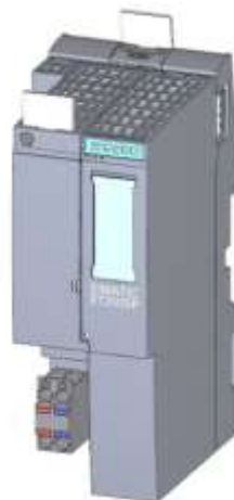
Hình 2.7. Phần cứng của Module Interface
