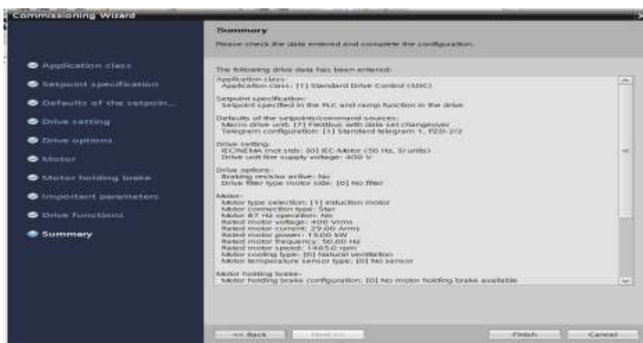
Hình 3.39. Kiểm tra thông tin sau khi cấu hình biến tần
