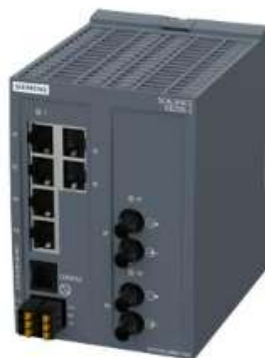
Hình 2.3. Bộ chuyên mạch SCALANCE
