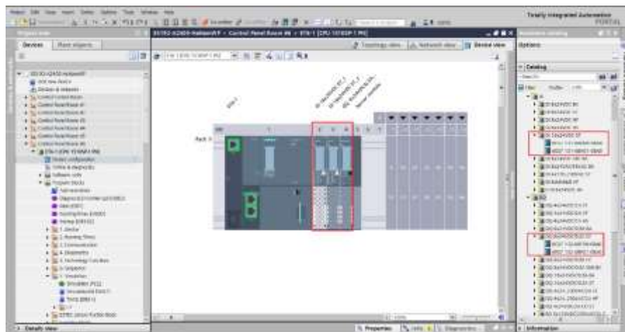
Hình 3.21. Lựa chọn module I/O cho ET 200SP
