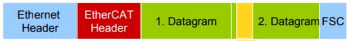
Hình 2.9: Cấu trúc của EtherCAT Data
