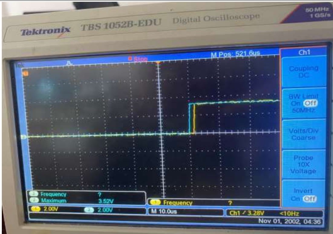
Hình 4.1: Độ lệch khi truyền dữ liệu từ TwinCat xuống 2 slave
