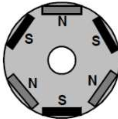
Hình 1.4 Rotor có nam châm ẩn bên trong lõi
