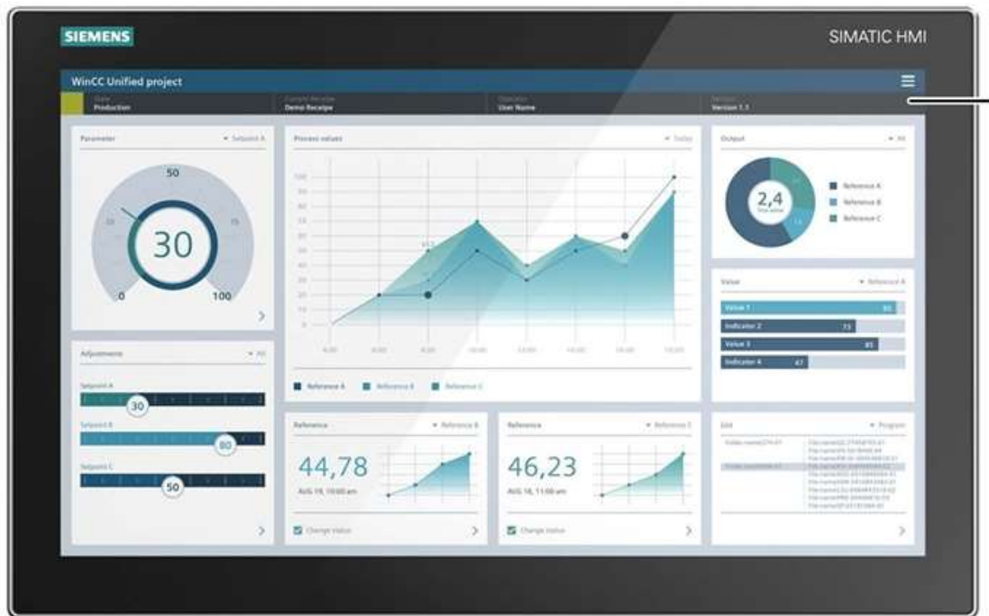
Hình 1.3.4 Màn hình SIMATIC HMI UNIFIED
