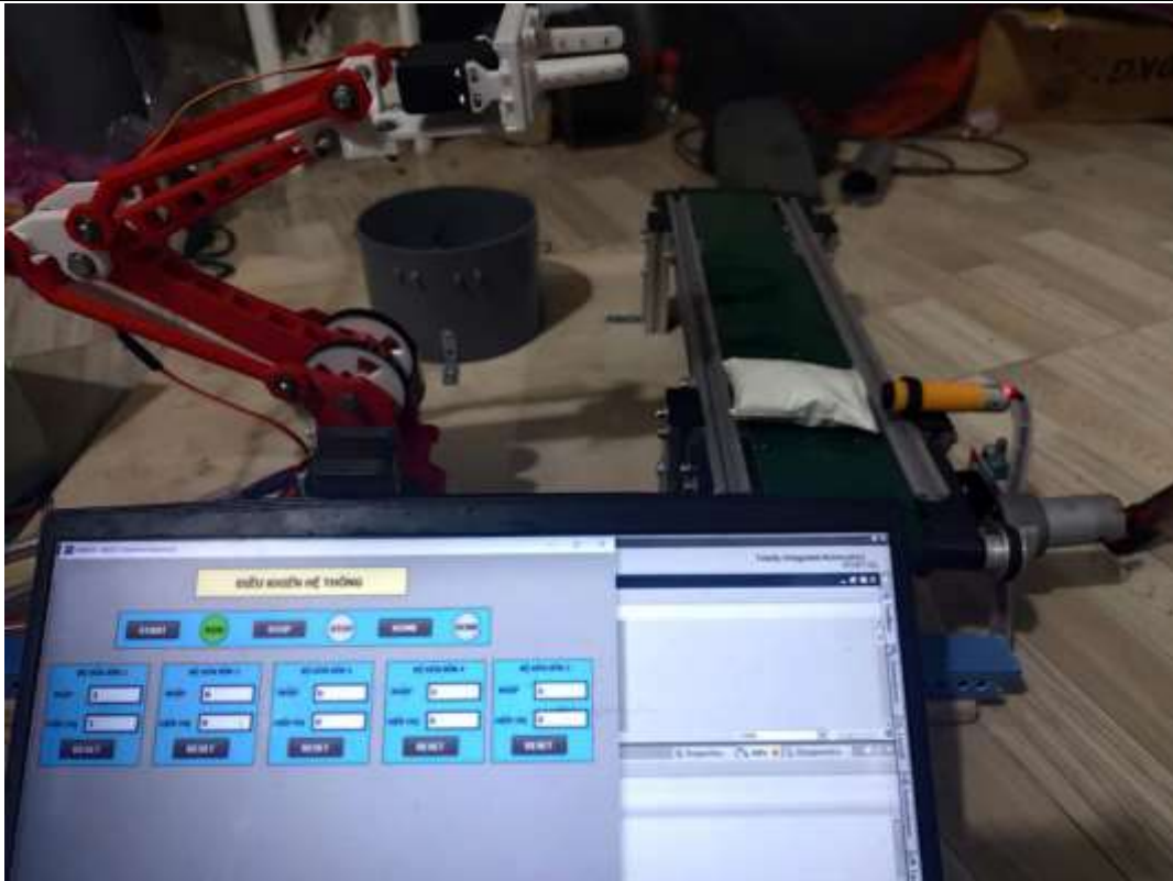
Hình 5.6 Hệ thống phát hiện bao tải tại vị trí thao tác
