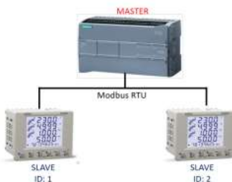
Hình 3.8: Thiết bị Master và thiết bị Slave.
