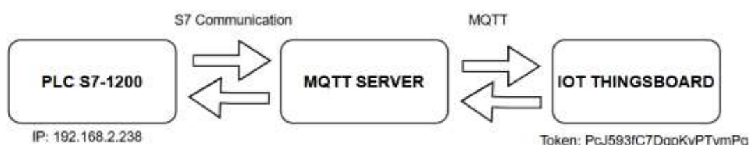
Hình 1.1: Cách kết nối giữa PLC Siemens với IoT ThingsBoard qua MQTT Server.
