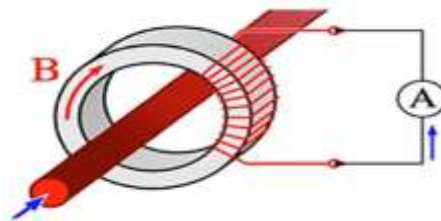
Hình 2.7: Nguyên lý hoạt động của biến dòng.
