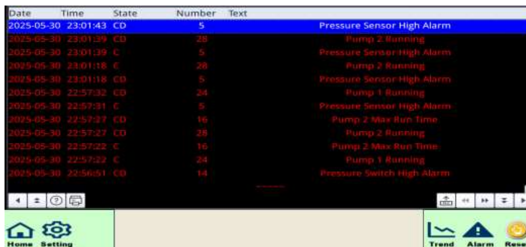
Hình 4.30 Giao diện trang Alarm
