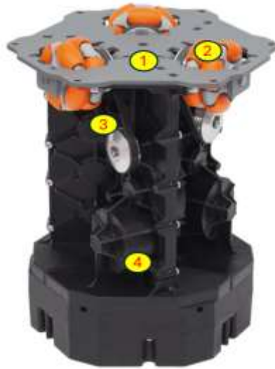
Hình 3.2: Cấu trúc chung của một tế bào module
