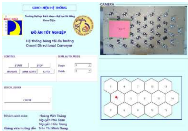
Hình 4.21: Giao diện điều khiển
