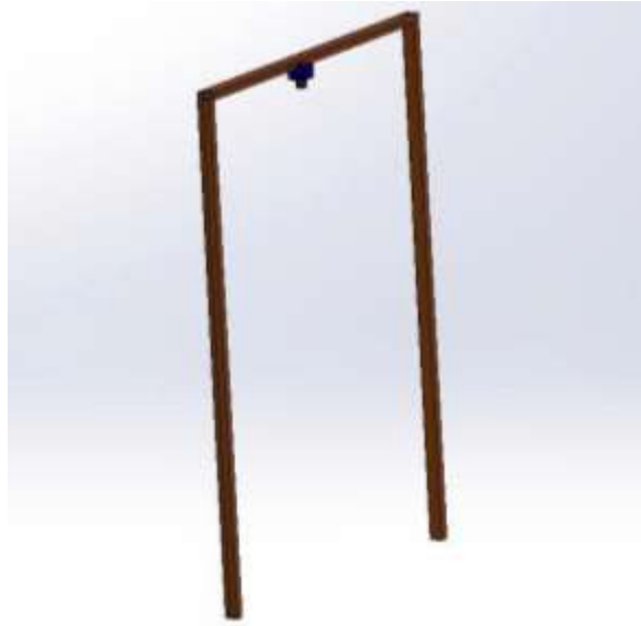
Hình 2.13: Khung gắn Camera
