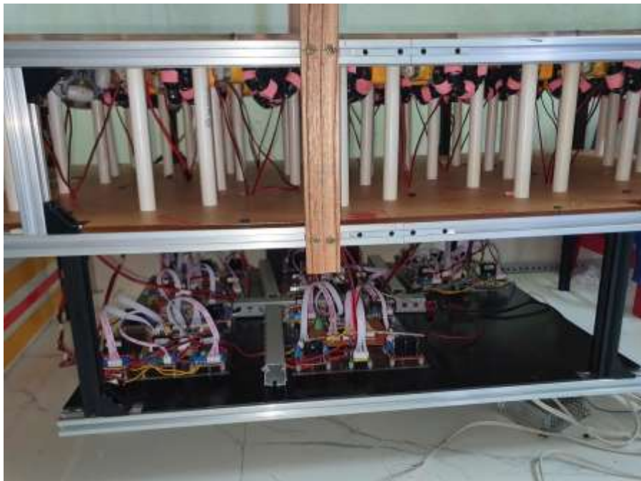
Hình 4.18: Thi công hoàn thiện khung đỡ cho bộ điều khiển
