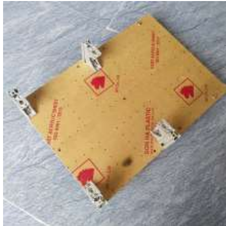
Hình 4. 3 Khung xe và giá lắp động cơ
