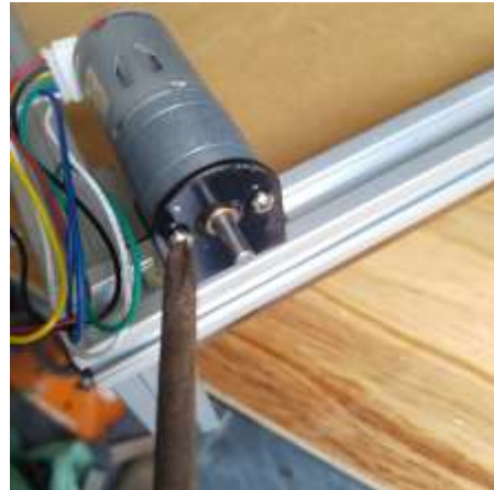
Hình 4. 3 Khung xe và giá lắp động cơ
