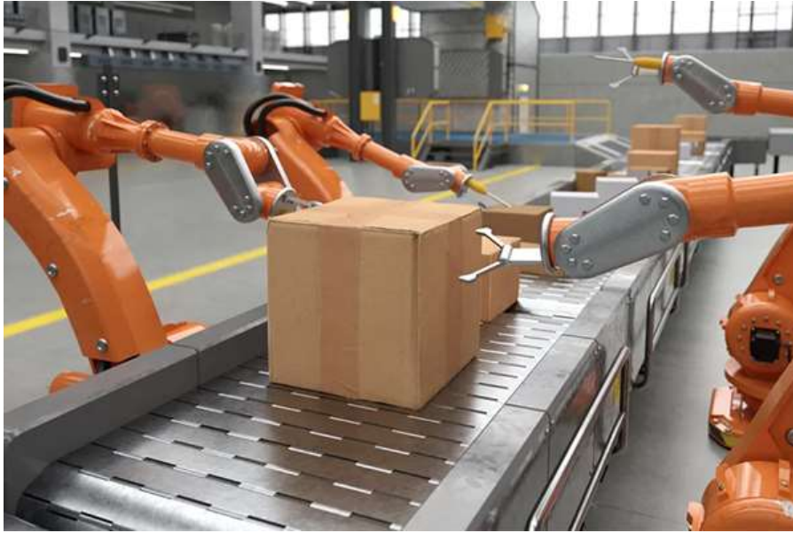
Hình 1.7: Cánh tay robot bóc xếp hàng hóa
