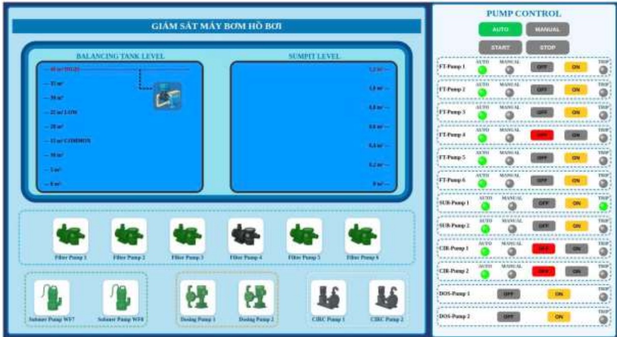
Hình 5.9 Điều khiển bơm thông qua Webservice
