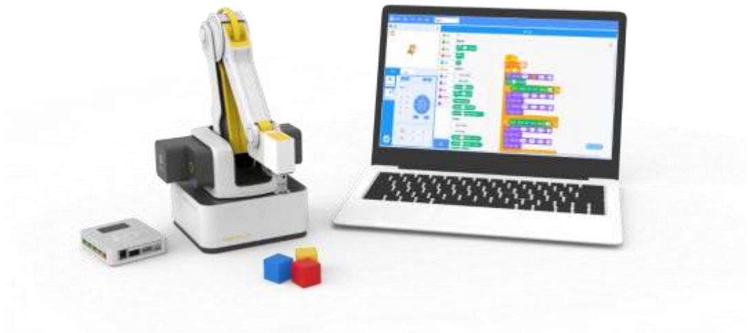
Hình 2.2: Cánh tay Robot 3DOF có tỷ lệ các khâu 1:1:1 dùng trong giáo dục và đào tạo
