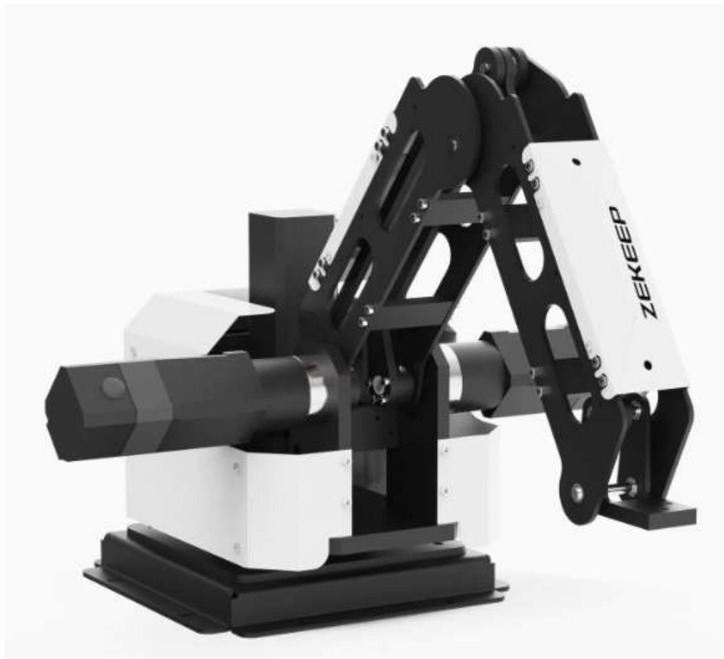
Hình 2.5: Mô hình cánh tay Robot 3 bậc tự do ZEKEEP mã số ZKBOT-3042B
