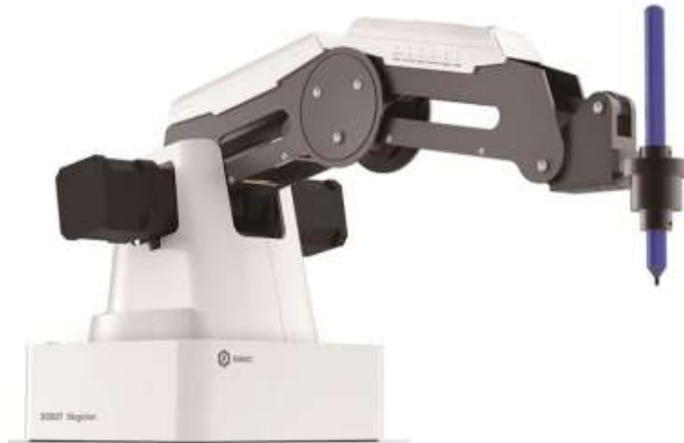
Hình 2.4: Cánh tay Robot 3DOF có tỷ lệ các khâu là 1:1.5:2 dùng trong vẽ 2D
