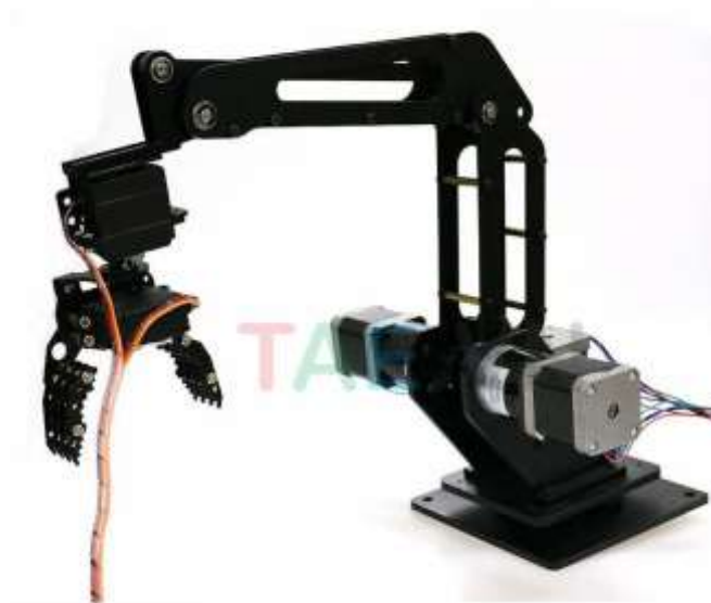
Hình 2.3: Cánh tay Robot 3DOF có tỷ lệ các khâu là 1:1.5:1 dùng trong ứng dụng gấp vật
