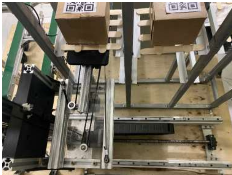
Hình 5-28. Kết quả cơ cấu ASRS đưa hàng vào kho
