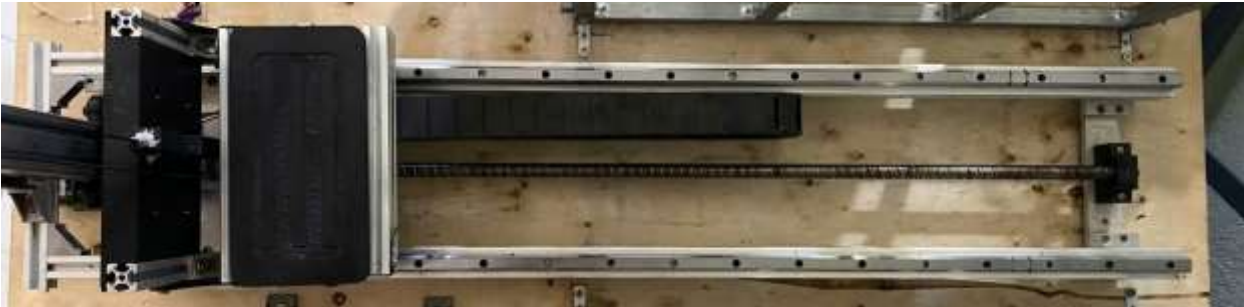
Hình 5-5. Kết quả thi công cơ cấu chuyển động trục X.
