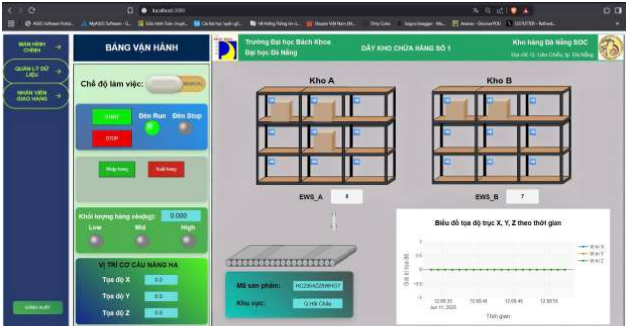
Hình 5-27. Kết quả hiển thị của mã QR và kết quả phân loại khu vực trên giao diện Web.
