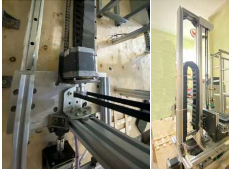
Hình 5-7 Kết quả thi công cơ cấu chuyển động trục Z.
