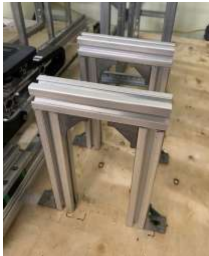
Hình 5-8. Kết quả thi công kệ hàng đầu ra.
