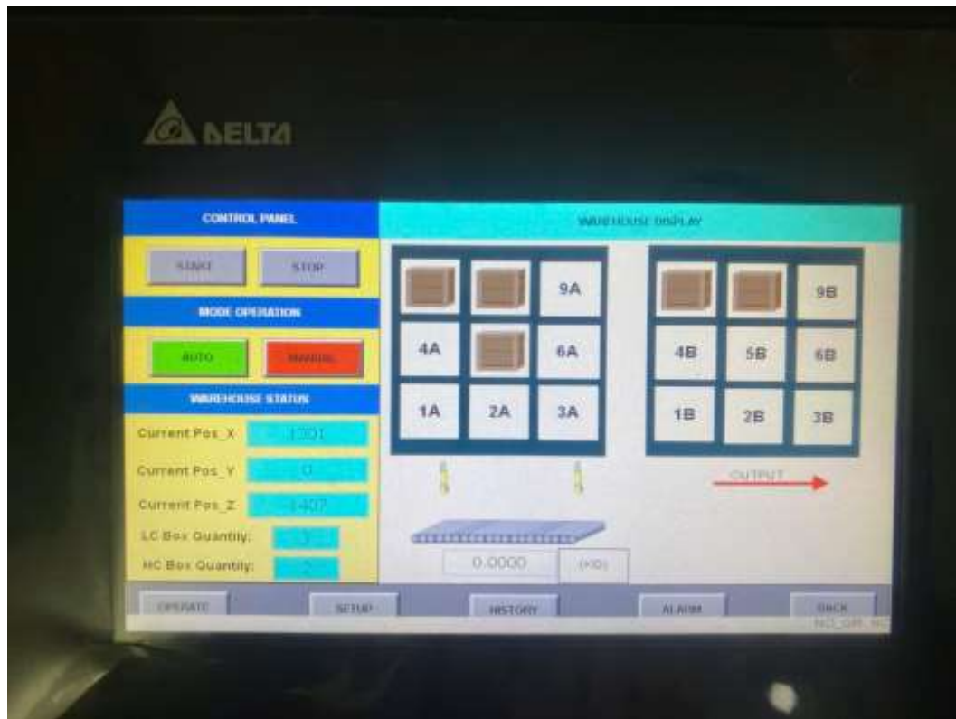
Hình 5-31. Kết quả theo dõi hàng trong kho và biểu đồ theo dõi vị trí 3 trục X, Y, Z trên giao diện HMI.
