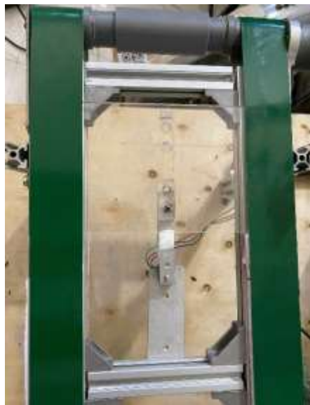
Hình 5-2. Kết quả lắp đặt cảm biến loadcell.
