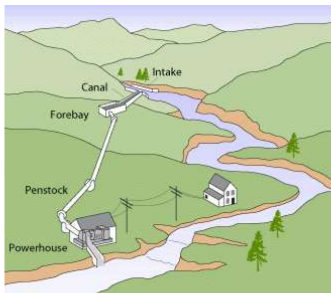
Hình 1.2. Sơ đồ của nhà máy thủy điện kiểu kênh dẫn
