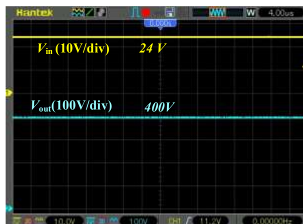
Hình 4.9 Đồ thị điện áp V_{in}=24V , V_o=400V .
