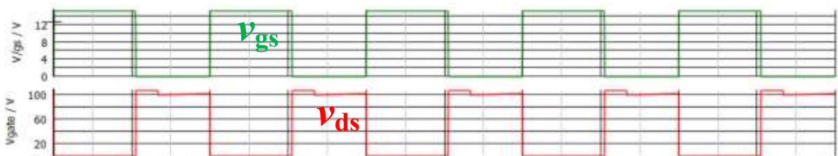
Hình 4.3 Hình ảnh kết quả mô phỏng dạng sóng v_{gs} và điện áp trên MOSFET.
