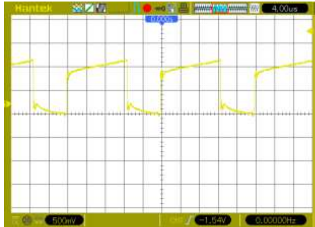
Hình 5.16 Dạng sóng thực nghiệm dòng điện rò qua cuộn I_{Lk}
