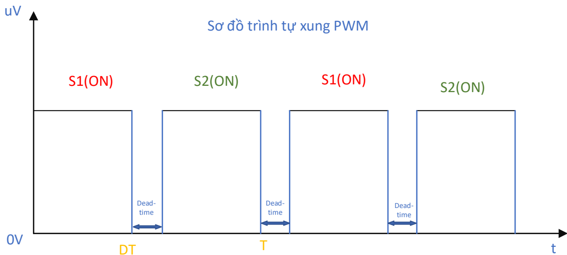
Hình 4.2: Sơ đồ trình tự xung PWM
