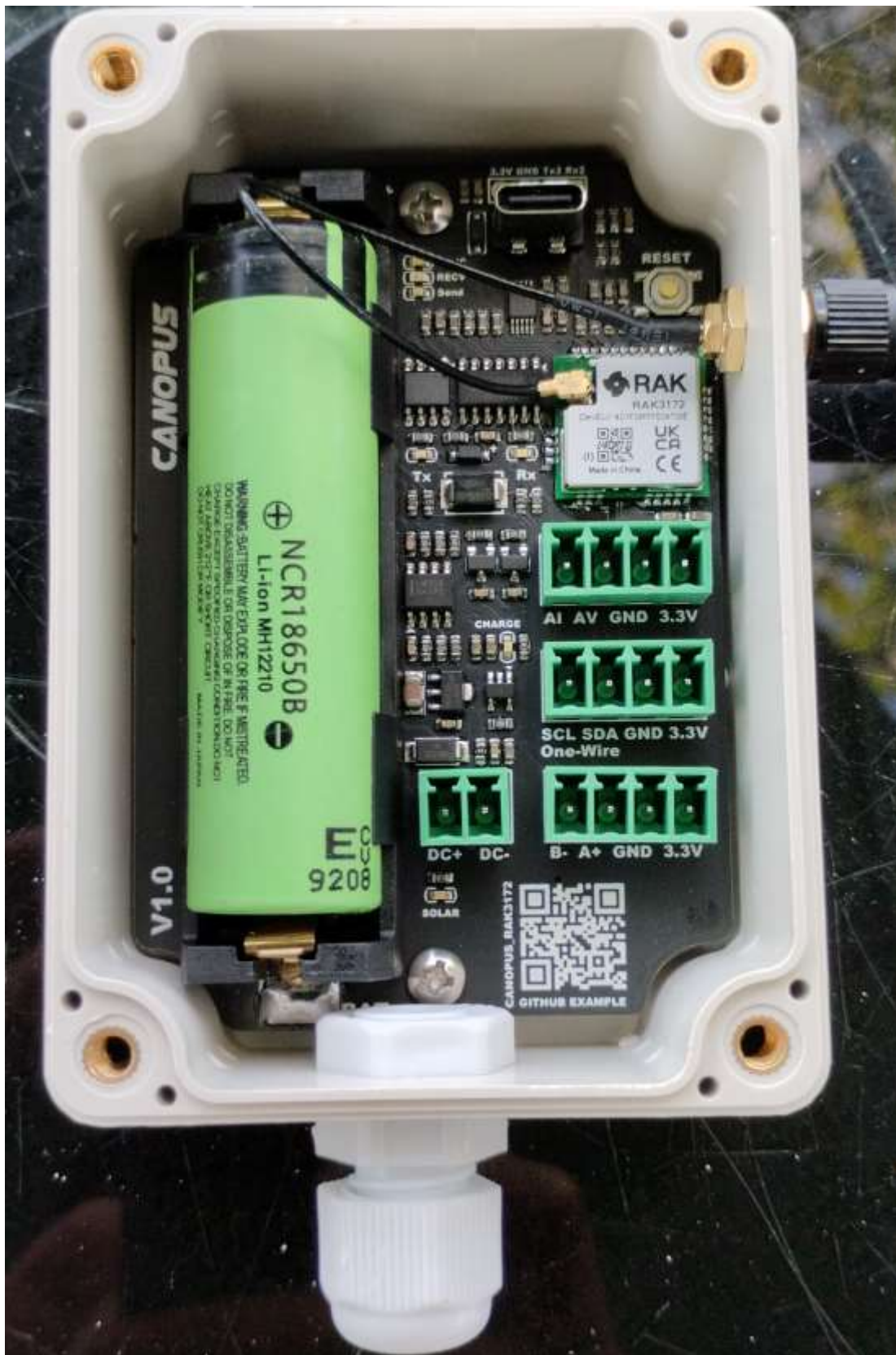
Hình 2.2 Bộ chuyển đổi truyền thông giao thức Modbus RTU sang Lora.
