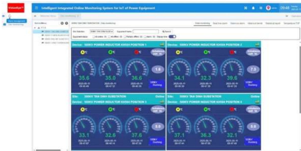
Hình 4.6 . Hiện thị các thông tin giám sát thực tế tại trạm biến áp
