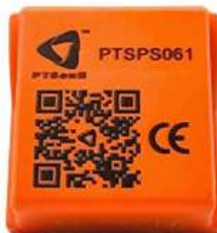
Hình 1.6 . Cảm biến nhiệt độ không dây PTSPS061
