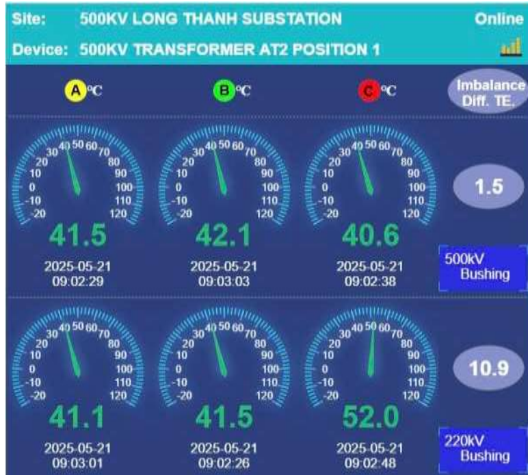
Hình 4.7 .Giao diện giám sát nhiệt độ thời gian thực của một thiết bị trong trạm điện
