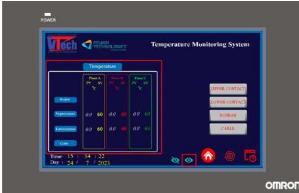
Hình 3.12 . Màn hình ở chế độ cho phép cài đặt thông số ngưỡng[4]
