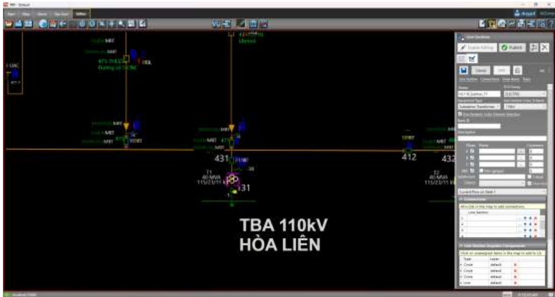
Hình 2.28 Tạo Substation Transformer trong Line Section (VD MBA T1 TBA 110kV Hòa Liên)
