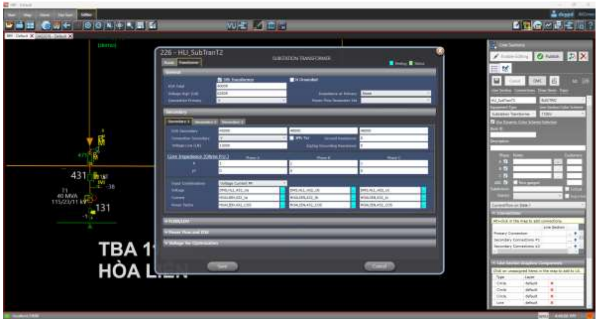
Hình 2.31 Cài đặt DMS cho máy biến áp (VD MBA T2 TBA 110kV Hòa Liên)
