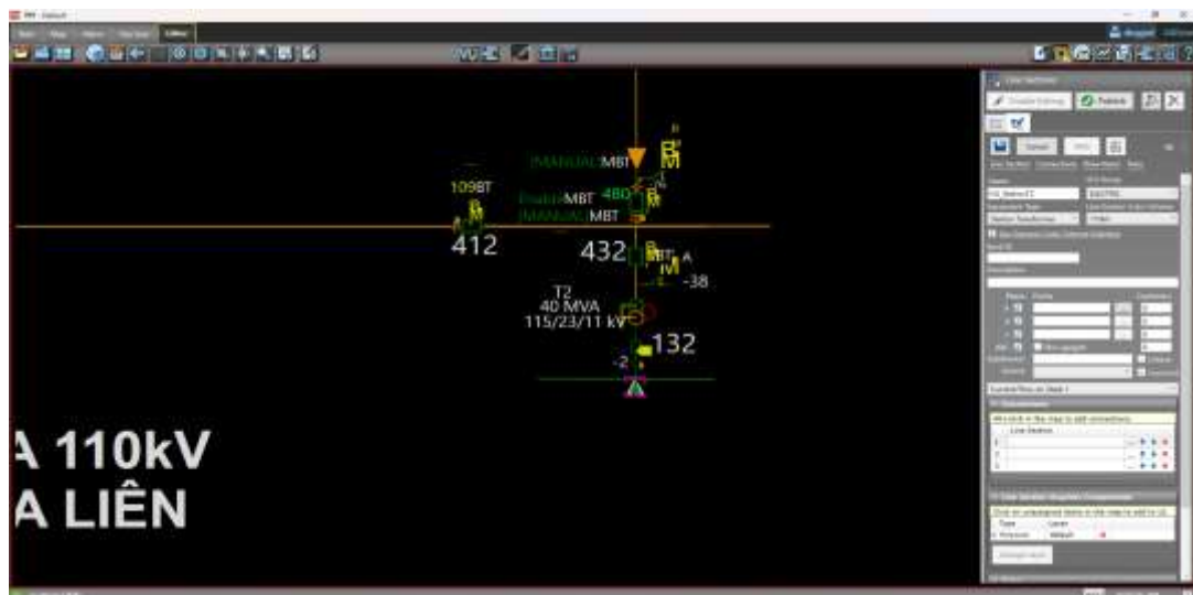
Hình 2.23 Tạo Station Transformer trong Line Section
