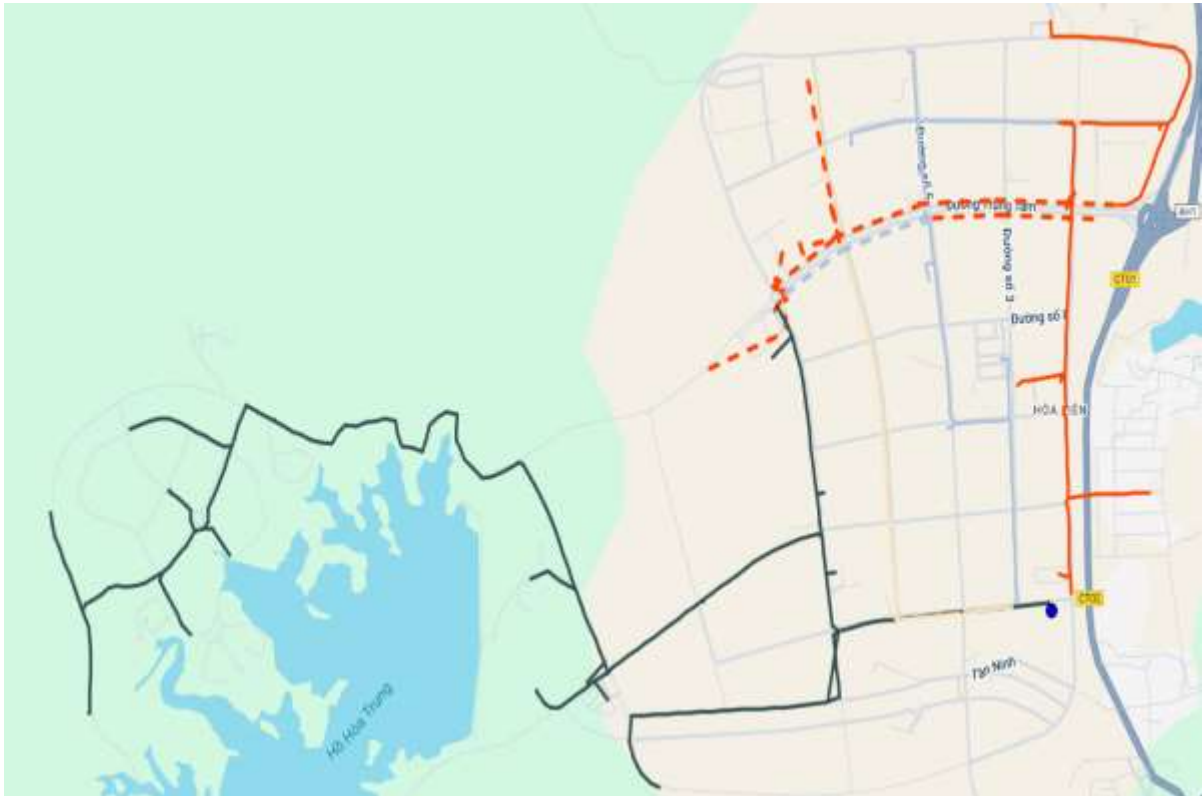
Hình 1.19 Các Xuất tuyến trung áp cung cấp điện cho Khu CNC trên hệ thống lưới điện trung thế
