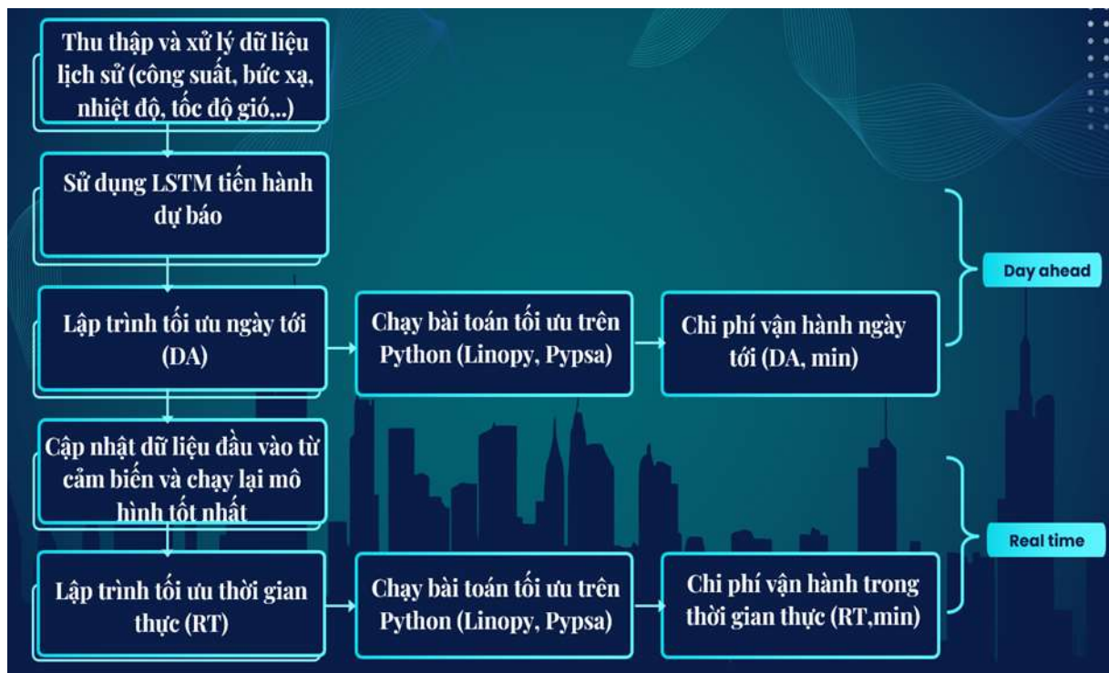
Hình 2.2. Lưu đồ thuật toán cấu trúc bài toán tối ưu bằng phương pháp đề xuất
