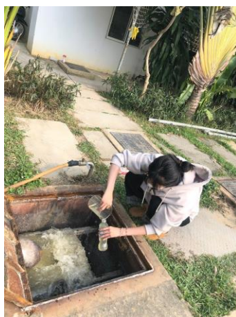
Hình 2. 6: Lấy mẫu tại trạm XLNT FPT
