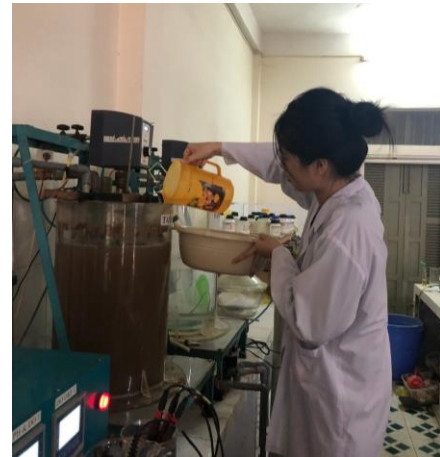
Hình 2. 15: Nạp nước thải vào mô hình
