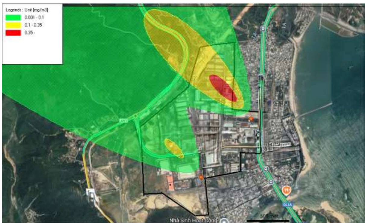
Hình 6.27 Kết quả khuếch tán SO 2 sau giải pháp của ống khói 2 và 4 hoạt động
