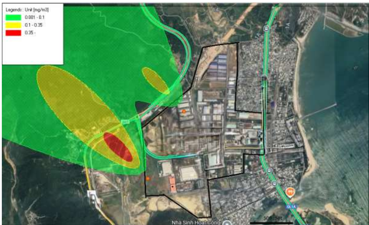
Hình 6.26 Kết quả khuếch tán SO 2 sau giải pháp của ống khói 1 và 3 hoạt động
