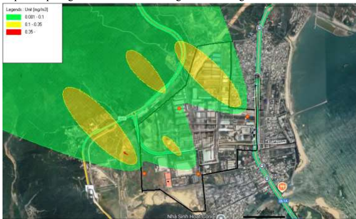
Hình 6.28 Kết quả mô phỏng khuếch tán sau khi nâng chiều cao ống khói
