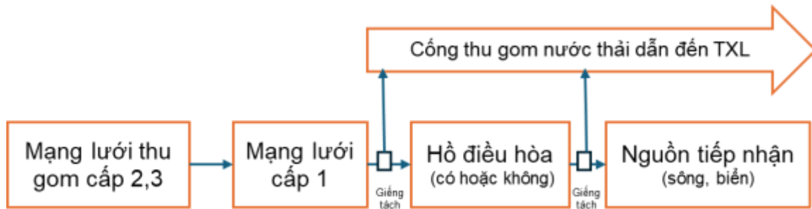
HÌNH 1. 3. SƠ ĐỒ TỔ CHỨC MẠNG LƯỚI THOÁT NƯỚC CHUNG CÓ CỐNG BAO
