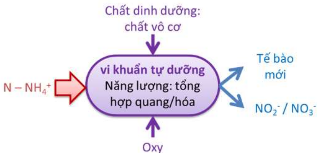
Hình 1. 1. Sơ đồ biểu thị quá trình Nitrat hóa
