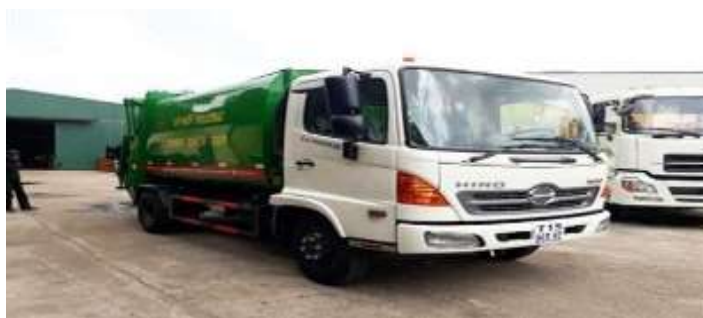
Hình 3.20: Xe cuốn ép rác V = 9 \text{ m}^3 thu gom rác tại chợ
