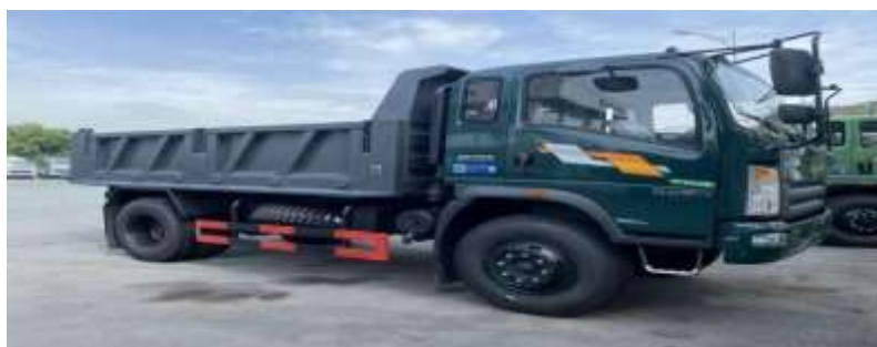
Hình 3.21: Xe ben có V = 10 m^3 thu gom chất thải rắn xây dựng
