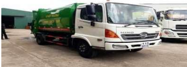
Hình 3.18: Xe cuốn ép rác V = 9 m 3 thu gom rác lề đường và điểm tập trung tại chỗ
