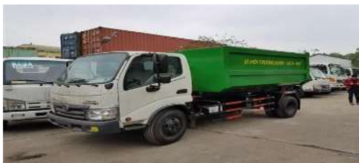
Hình 3.17: Xe hooklift V = 9 m 3 thu gom rác tại trạm trung chuyển
