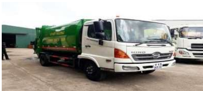
Hình 3.19: Xe cuốn ép rác V = 9 \text{ m}^3 thu gom rác diêm tập kết tạm thời
