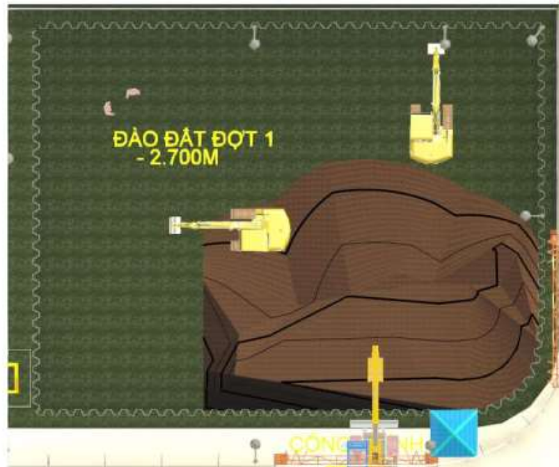
Hình 7.6. Thi công đào đất giai đoạn 1
