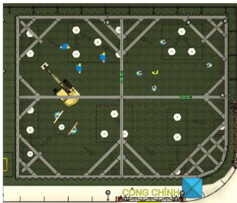
Hình 7.9. Thi công đào đất giai đoạn 4
