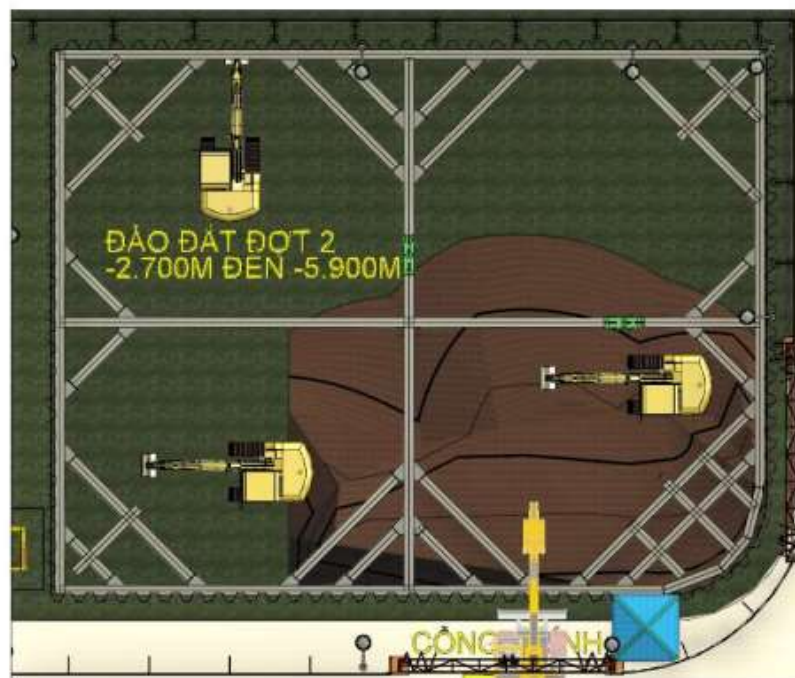
Hình 7.7. Thi công đào đất giai đoạn 2
