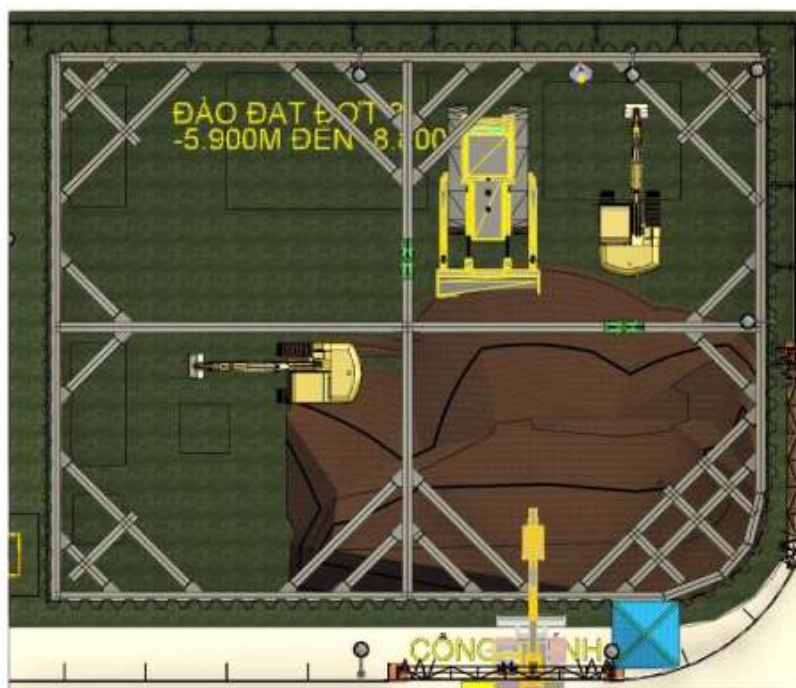
Hình 7.8. Thi công đào đất giai đoạn 3
