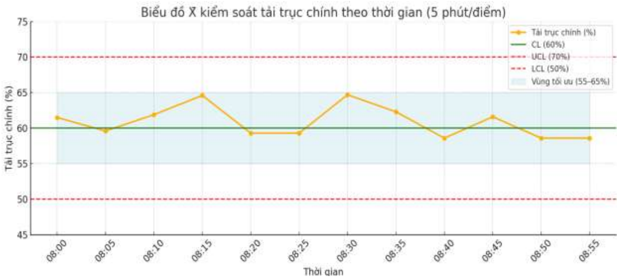
(Hình 4.17 Biểu đồ kiểm soát tải trực chính)
