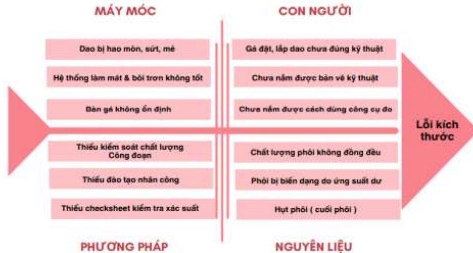
(Hình 4.3 Biểu đồ xương cá phân tích lỗi kích thước)
