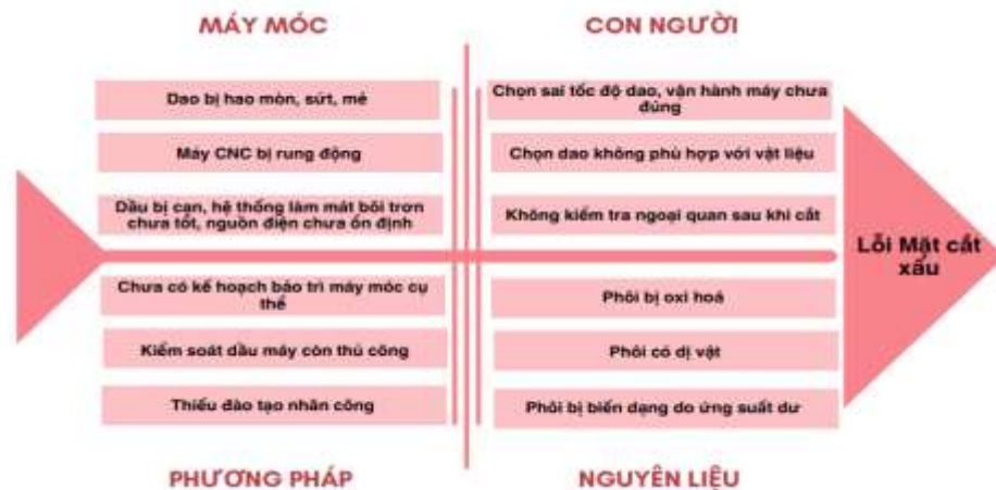
(Hình 4.4 Biểu đồ xương cá phân tích nguyên nhân gây lỗi mặt cắt xấu)
