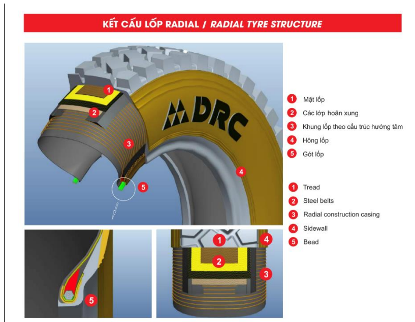
Hình 3.4: Cấu trúc cơ bản của Lốp Radial
