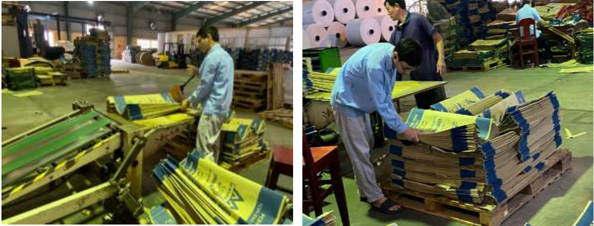
Hình 3.29 Công nhân cắt bao xi măng để định hình bao đúng kích thước
