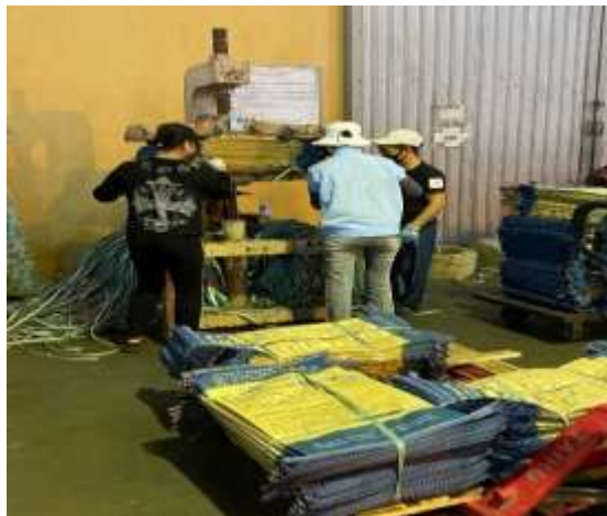
Hình 3.35 Công nhân đang ép kiện bao xi măng
