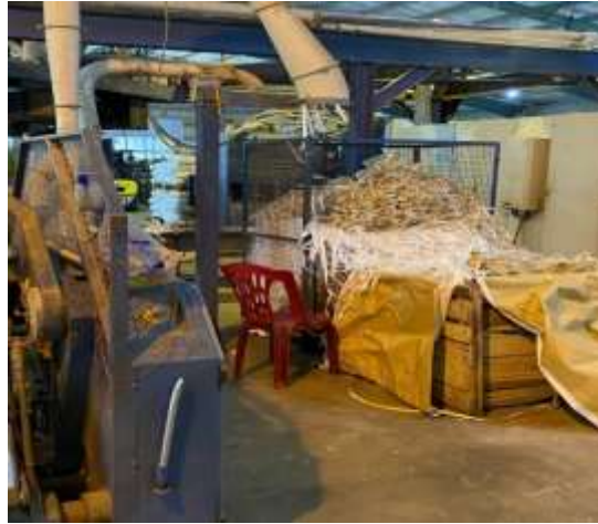
Hình 3.22 Máy cắt vĩa mép hai bên cuộn vải PK
