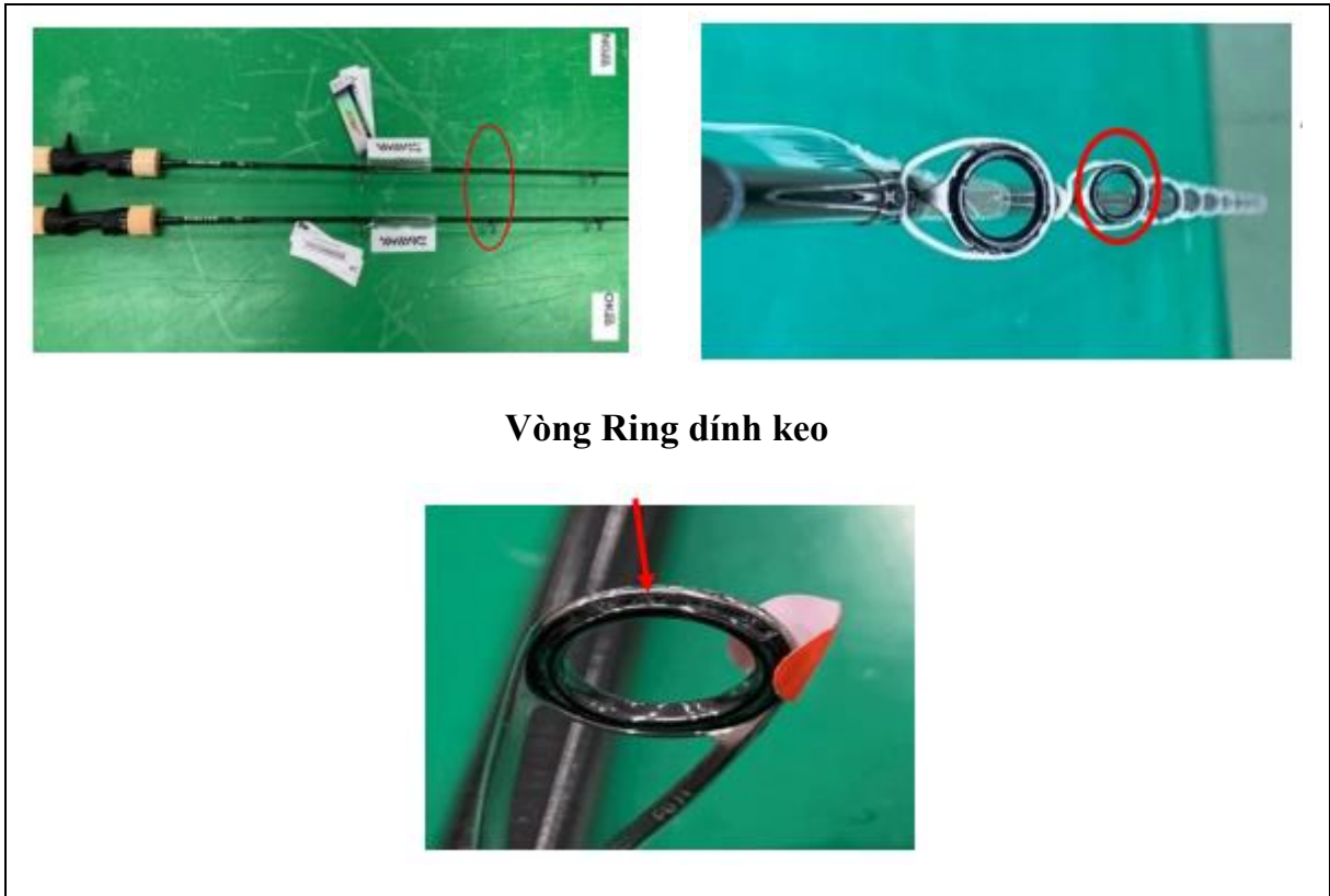
Hình 4. 3 Một số lỗi tại bộ phận lắp ráp
