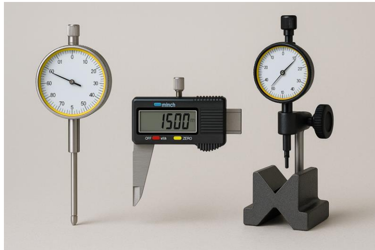
Hình 3.2 Hình minh họa đồng hồ so, thước kẹp điện tử, bộ gá kiểm tra trục
