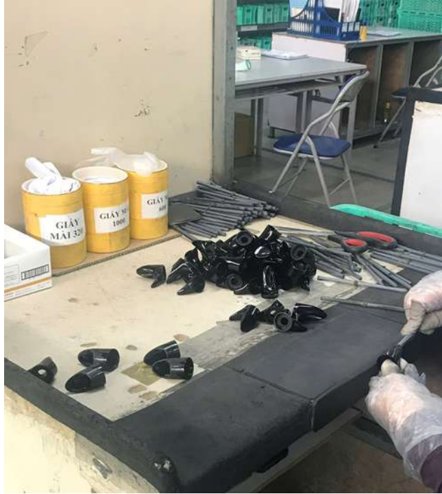
Hình 4. 9 Vật tư và bán thành phẩm đặt sai vị trí tăng nguy cơ trầy xước
