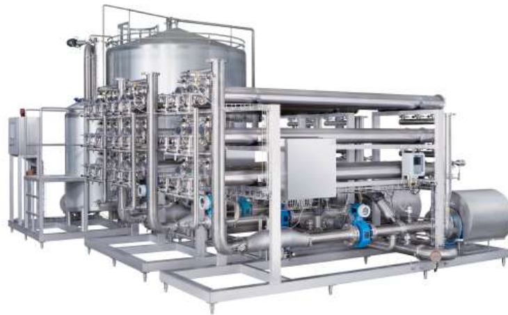
Hình 2.7 Hệ thống siêu lọc lần 2
