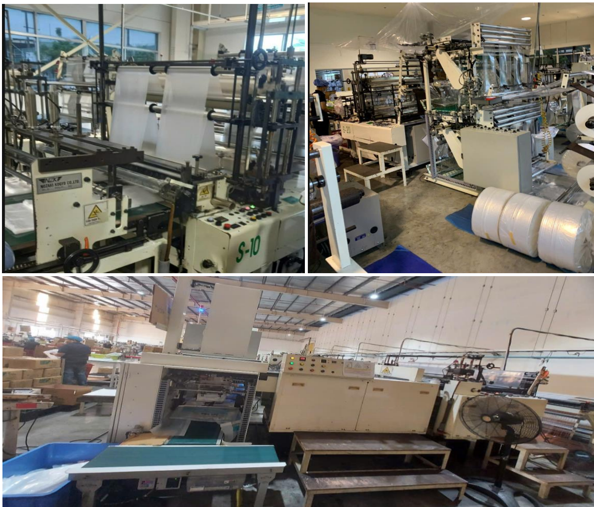
Hình 3-10: Một số hình ảnh của dây chuyền cắt, dập seal và đóng gói sản phẩm. (Nguồn: Được sinh viên chụp tại công ty Apple Film Đà Nẵng)
