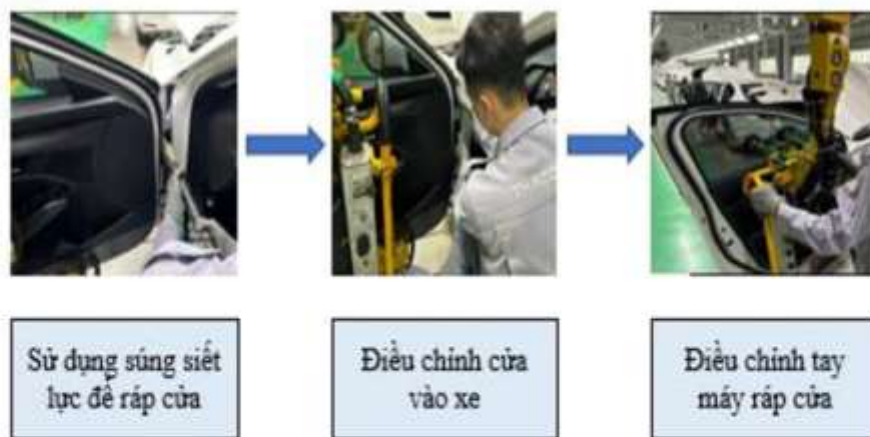
Hình 20: Quy trình lắp ráp cửa vào xe
