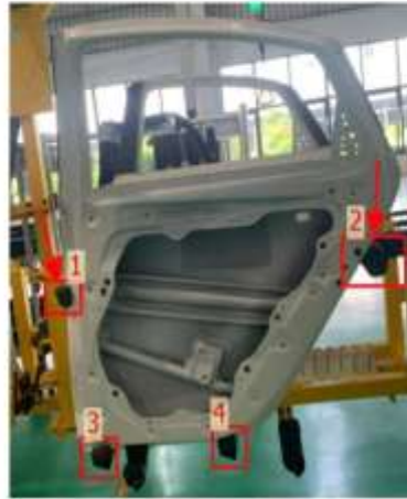
Hình 35: Các vị trí cửa tiếp xúc với Hanger
